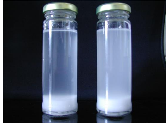
图 5-7 进口（左）和国产熔融石英砂（右）粉尘含量对比
