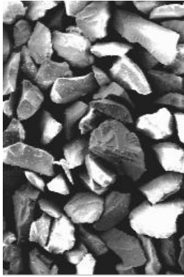
图 5-6 熔融石英砂（左）和锆石砂（右）的粒形对比
